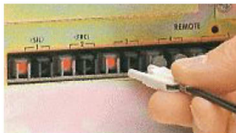
図 9 システムコントローラー背面と光ファイバーケーブル
