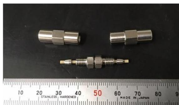
図 2 開発したモノリス形シリカマイクロトラップカラムの外観
