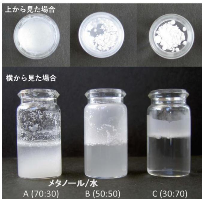
図 7 メタノール/水の混合溶液中で超音波振動を加えた状態で攪拌した C18 充填剤の分散状態
