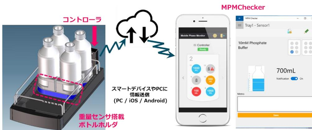
図 2 MPM-40 とスマートデバイスによる連携による移動相残量のモニタリング
